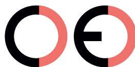
Marca CE falsa (demasiado separados)
